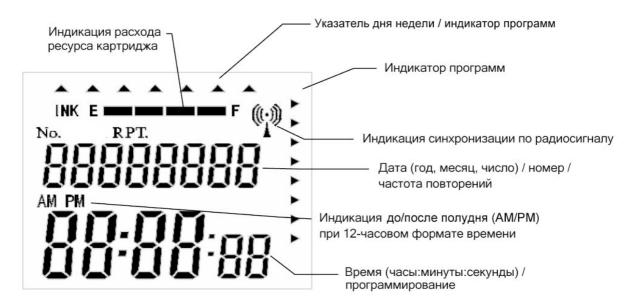
На ЖК дисплее имеется индикатор расхода ресурса картриджа. Индикатор отображает состояние картриджа в виде горизонтальных прямоугольников. Левая граница индикатора – Е (Empty, пусто), правая граница индикатора – F (Full, полный ресурс).
