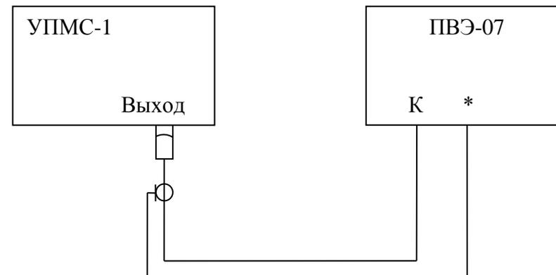
Рис.10.1. Схема подключения приборов при определении погрешности секундомера
