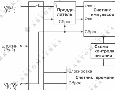
Рис. 11. Прямой счет импульсов с возможностью блокировки и сброса по отдельным входам
