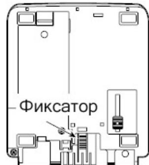
2. Используя заднюю крышку прибора в качестве шаблона, просверлить необходимое нижнее отверстие в стене для надежного крепления прибора.
