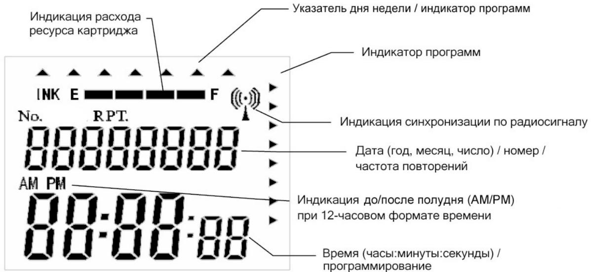
На ЖК дисплее имеется индикатор расхода ресурса картриджа. Индикатор отображает состояние картриджа в виде горизонтальных прямоугольников. Левая граница индикатора – E (Empty, пусто), правая граница индикатора – F (Full, полный ресурс).
